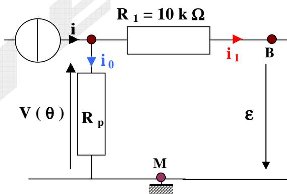
D'autre part, on sait que :  $R_p \approx 100 \Omega$  ;  $R_1 = 10 \text{ k}\Omega$  ; on a donc :  $R_1 \gg R_p$ .
