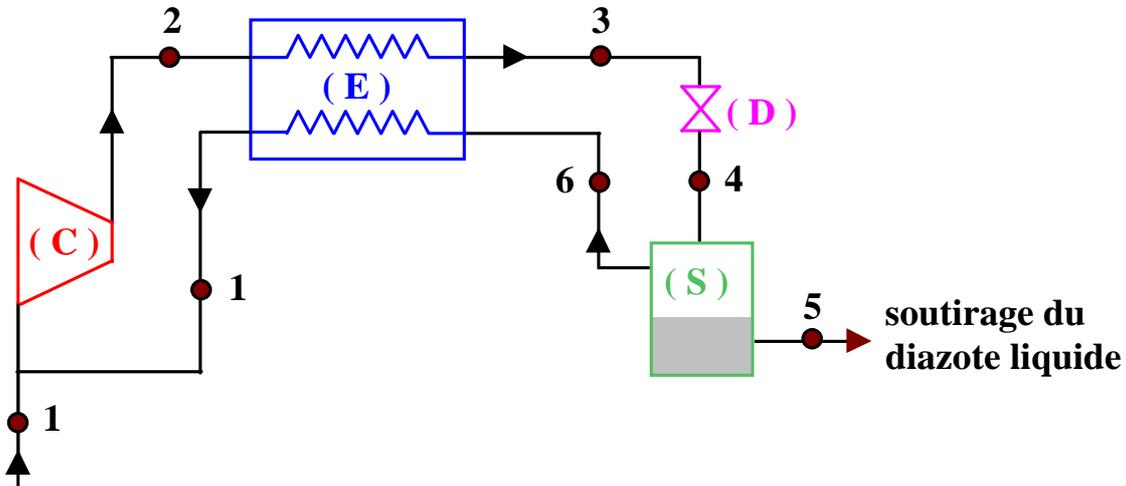
L'azote entre dans le compresseur (C) dans l'état 1 caractérisé par  $p_1 = 1 \text{ bar}$  et  $T_1 = 290 \text{ K}$  ; il y subit une compression qui l'amène à la pression  $p_2 = 200 \text{ bar}$  .
