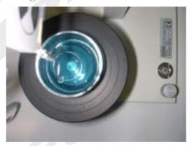
En tournant la vis (5) dans le sens horaire, abaisser la table de mesure jusqu'à ce que le bras d'équilibre (9) descende à la limite inférieure de l'indicateur blanc du repère (7); Dans ce cas, l'anneau est maintenu par la surface du liquide. La mesure réelle commence à ce moment!
