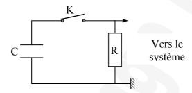
A l'instant  $t = 0 \, s$ , on ferme l'interrupteur K. Un système d'acquisition permet d'enregistrer pendant 4 heures l'évolution de la tension aux bornes du condensateur en fonction du temps. La courbe obtenue est représentée sur le document 5 à rendre avec la copie.
