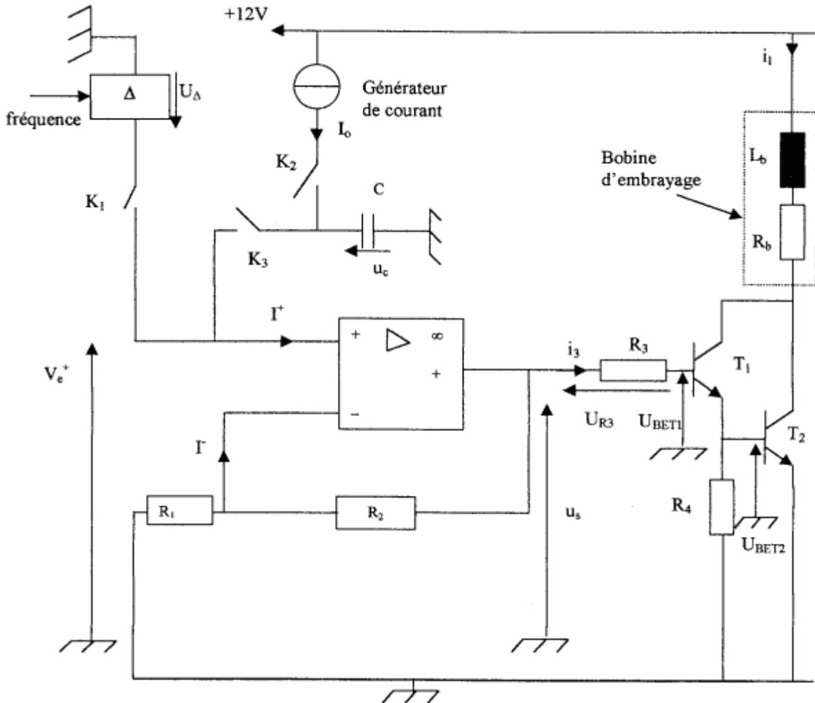
La bobine de l'embrayage est équivalente à une résistance  $R_b$  montée en série avec une inductance  $L_b$ , susceptible d'être traversée par un courant  $i_L$ .
